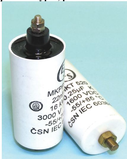
Válcové pouzdro typ P, pro VN kondenzátory
